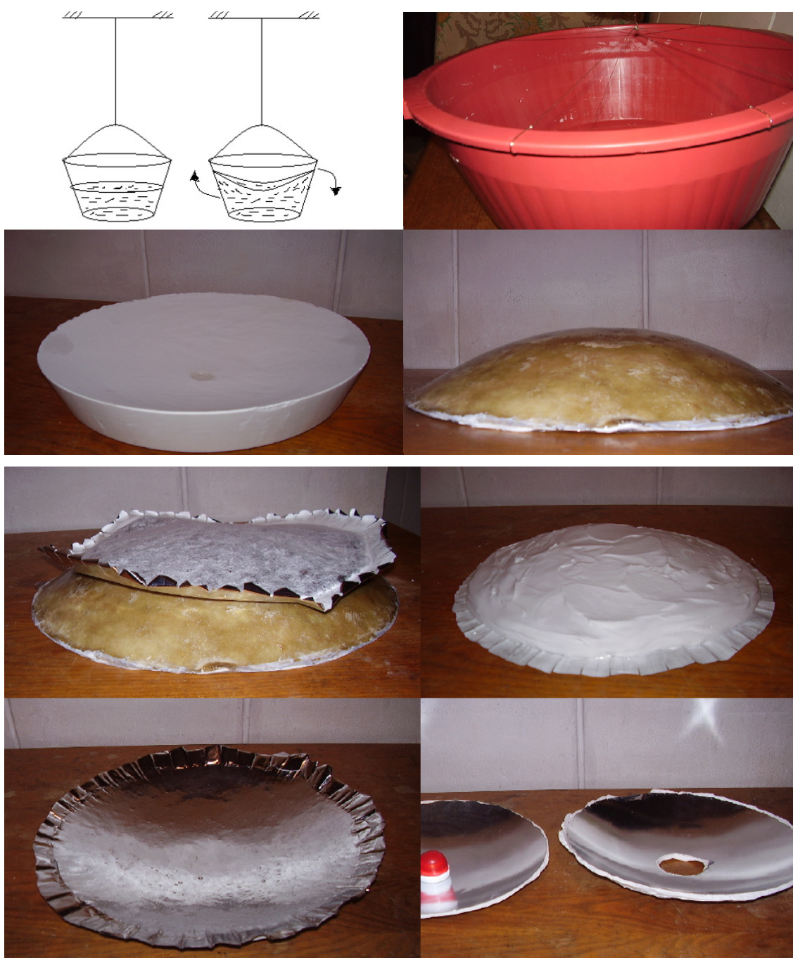
Figura 23 – Construção de um espelho parabólico pelo método do balde de Newton [10].
